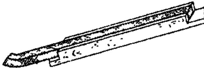
Fig. 20 – Dispositivo para cortar anillos de Prensaestopa
