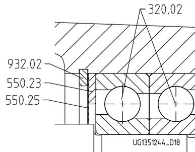
**Fig. 18:** Montar los cojinetes de resistencia media
