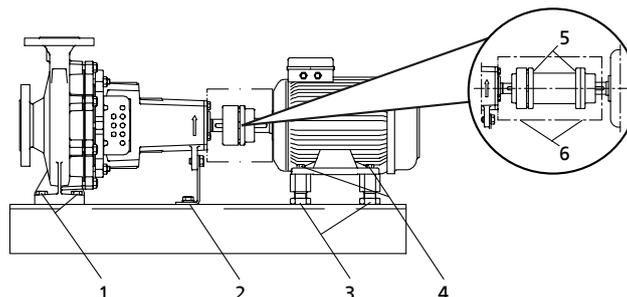
Fig. 22: Posiciones de apriete de los tornillos del grupo motobomba
