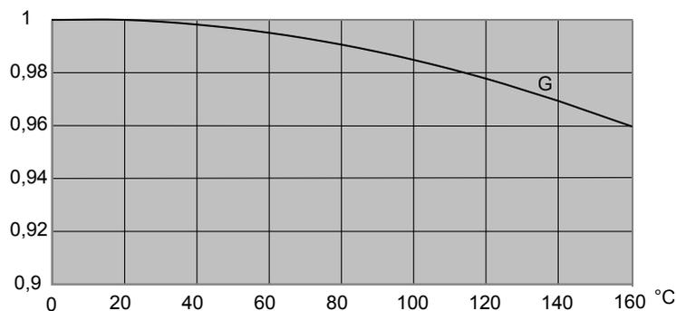
Fig. 12: Diagrama de corrección de la temperatura para la ejecución "G" (JL1040/A48CL35B)
