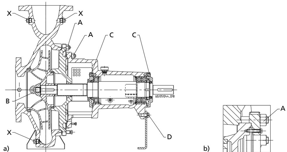
**Fig. 20:** a) Posiciones de apriete de los tornillos de la bomba, b) Versión con tapa de la carcasa encajada
