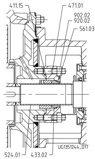
Cierre mecánico con tapa de carcasa cilíndrica (modelo "h" calefactable)
