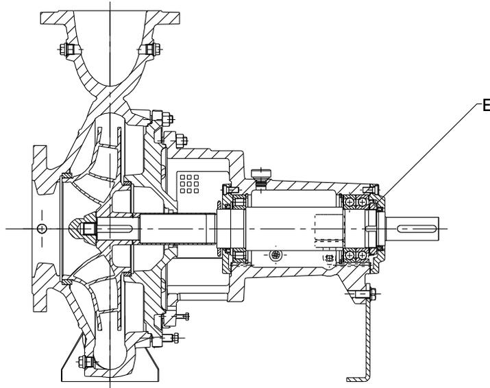
Fig. 21: Posiciones de apriete de los tornillos de la tuerca del eje
